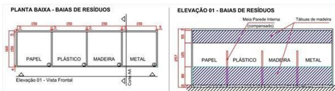
Figura 5 - Representação esquemática das baias de resíduos (dimensões em centímetros)
