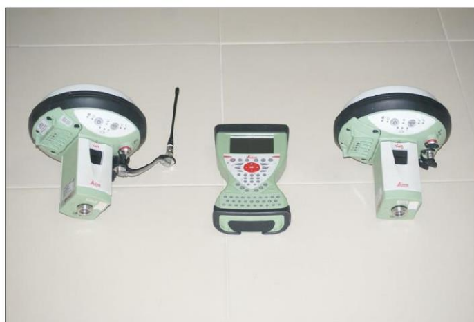
Figura 2. GPS GS15: da esquerda para direita, GPS Móvel, controladora e GPS Base.
