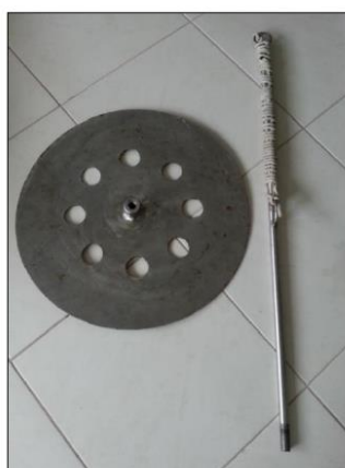
Figura 9. Disco metálico para a calibração do sonar.
